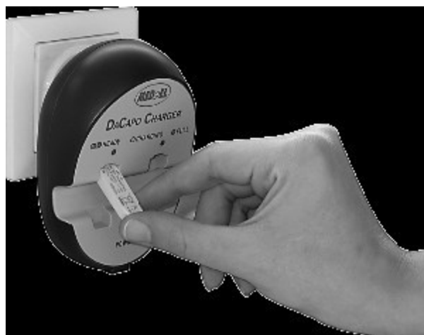
Рис. 3.8. Замена и зарядка аккумулятора для процессора Orus 2 (Med-El) с помощью зарядного устройства Da Capo
